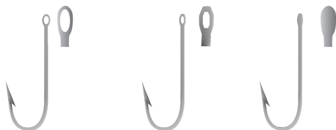
Tipos de anzóis: ponta de argola (com olhal), ponta de agulha e ponta de chapa (sem olhal)
